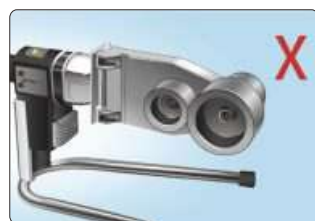
Неправильное крепление нагревательных насадок
