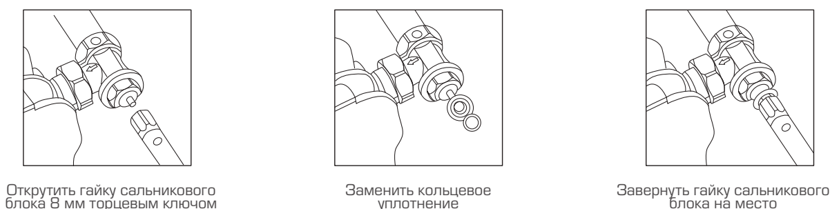
Рис. 21. Замена кольцевого уплотнения штока клапана терморегулятора
