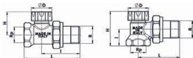
Рис. 31. Устройство запорно-балансировочного клапана типа SVL
