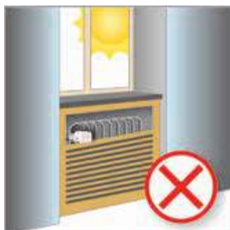
Рис. 8. Требования по размещению автоматического терморегулятора
