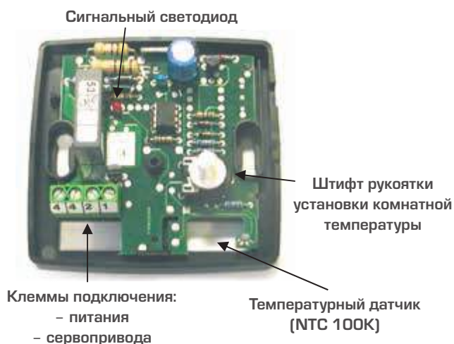
Рис. 12. Устройство электронного термостата для напольного отопления
