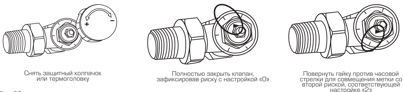
Рис. 20. Пример преднастройки клапана терморегулятора
