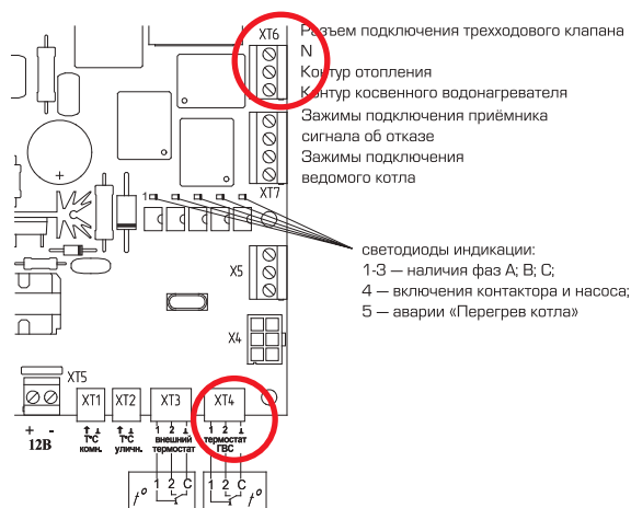
Рис. 13. Схема подключения датчика температуры бойлера
