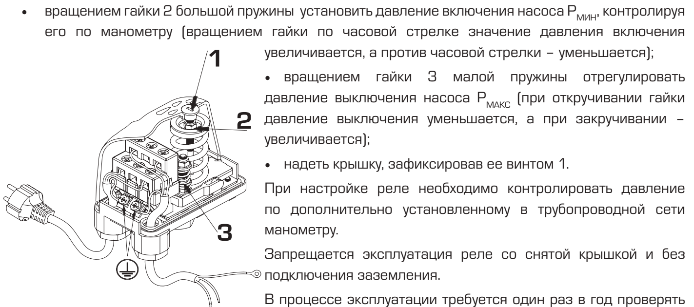
Рис. 24. Устройство реле давления
