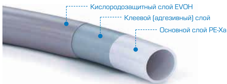
Рис. 1. Трехслойная труба РЕ-Ха/EVONH
