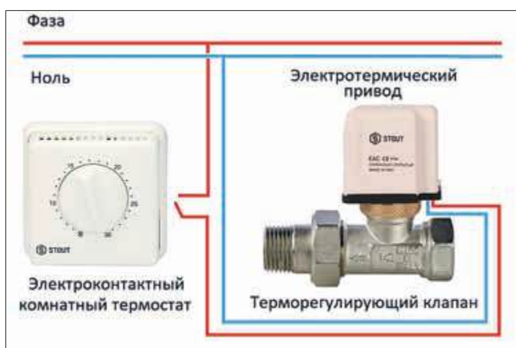
Рис. 3. Схема электрических соединений сети управления
