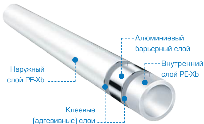
Рис. 5. Пятислойная металлополимерная труба РЕ-Хб/Al/РЕ-Хб
